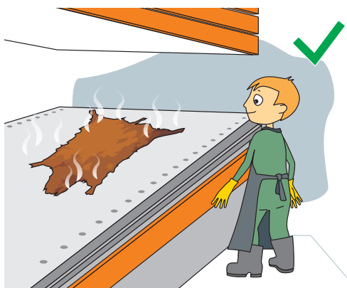
Фиг. 1 Правилна работа. Не поставяйте ръцете си върху рамката преди повдигане и смукване на вакуумната глава.
