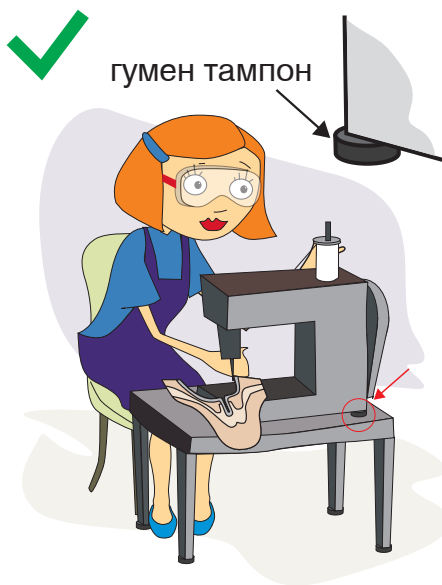
Фиг.3 Осигуряването на антивибрационни и шумозаглушителни подложки на машините намалява действието на тези фактори.
