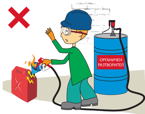
Фиг.4 Този начин на работа е опасен за вас и за работещите около вас. При не заземяване на металното оборудване съществува опасност от образуване на статично електричество и следствие: пожар или експлозия.
