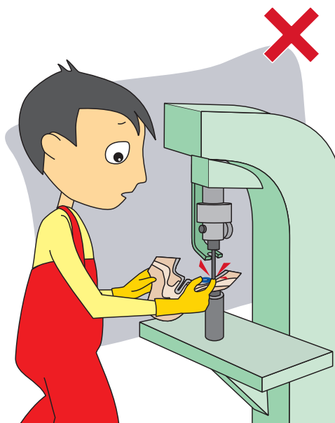
Фиг.4 Неправилна работа. Неизползването на специализирани инструменти при настройката на машината за тик-так копчета води до притискания, порязвания и нараняване. Това е опасен начин на работа.
