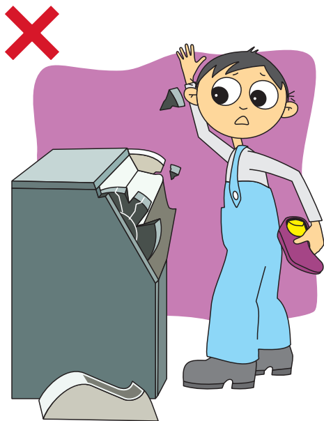
Фиг.2 Неправилна работа. Не работете при свалени предпазни капаци на машините. Това може да коства здравето и дори живота ви.
