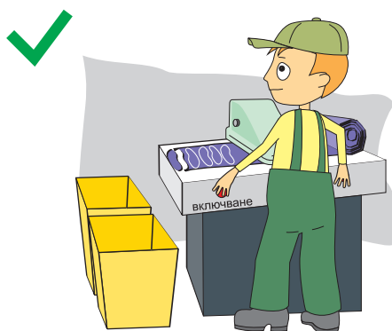
Фиг.3 Правилна работа. Запомнете, при работа с щанц машина и двете ръце трябва да са ангажирани с пусковите бутони.
