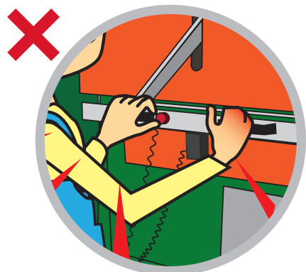
Фиг.2 Неправилна работа. Неангажирането на двете ръце често води до тежки последствия – притискане, изгаряне.
