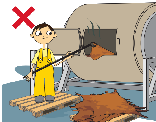
Фиг.4 Неправилна работа. Не работете така. Рискувате тежки наранявания при самоволно спиране на движещ се барабан с ръка.
