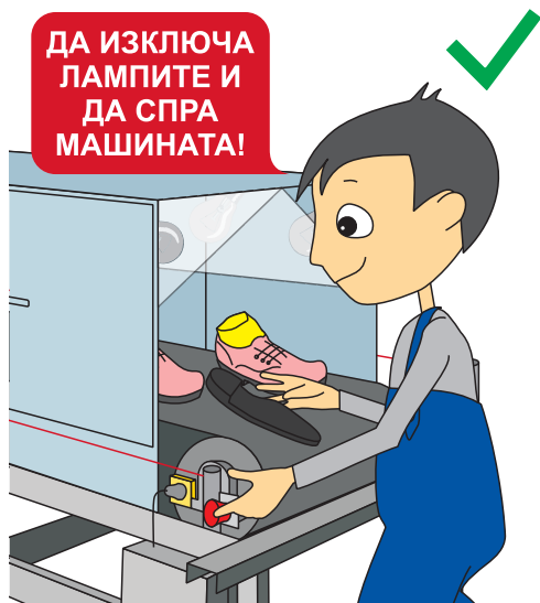
Фиг.3 Правилна работа. Лентата е спряна, лампите са изключени. Този начин на работа елиминира следните опасности: допир до движеща се лента, гореща повърхност и контакт на очите с инфрачервена светлина.
