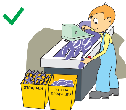
Фиг.1 Правилна работа. Кожата се подава правилно за разкрояване и се извършва своевременно отстраняване на отпадъците.
