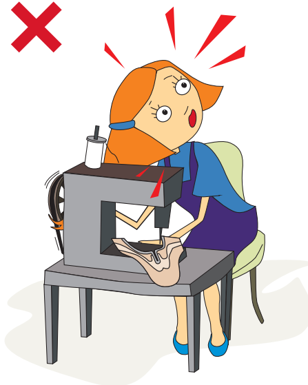
Фиг.2 Не работете така. Липсата на защитни устройства води до тежки наранявания.
