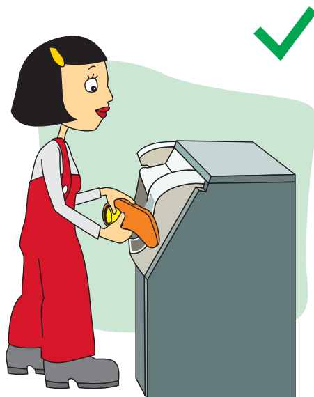
Фиг.3 Правилна работа. Дръжте ръцете на безопасно разстояние от режещия инструмент /шкурка или шмиргел/.
