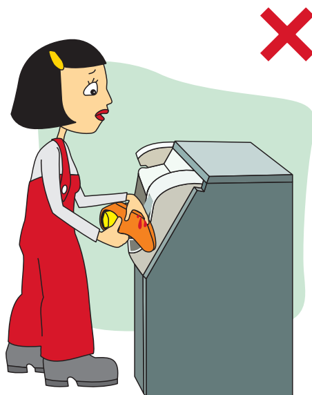
Фиг.4 Неправилна работа. Всяко съприкосновение на ръката с режещия инструмент ще предизвика нараняване.
