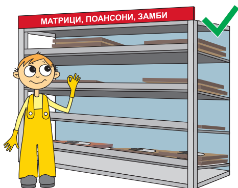
Фиг.1 Правилна работа. Правилното подреждане на остри инструменти (на рафтове с наклон към задната страна), намалява опасността от порязване.
