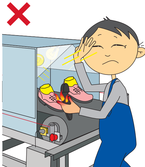
Фиг.4 Неправилна работа. При работа по този начин рискувате нараняване от движещата се лента, изгаряне при допир до гореща повърхност и осветяване на очите от инфрачервена светлина. Не работете така.
