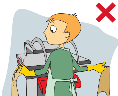
Фиг.4 Този начин на работа е опасен. Липсата на дистанция от горещата притискаща преса води до наранявания.
