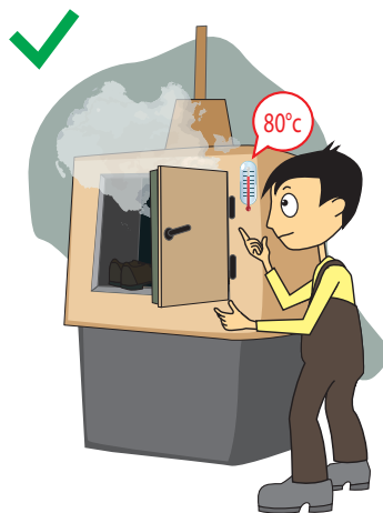
Фиг.3 Правилна работа. При отваряне на навлажнителните камери стойте зад вратата на камерата и далече от излизащата пара.
