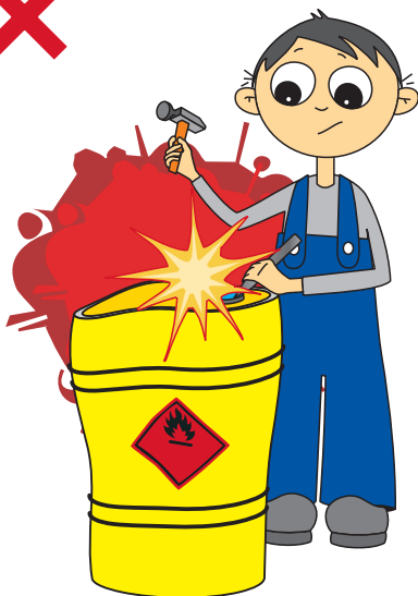
Фиг.2 Неправилна работа. Отварянето на съд със запалимо вещество, посредством метален инструмент може да предизвика искрене, запалване, пожар и/или експлозия.
