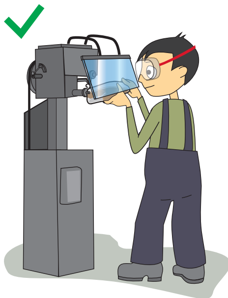
Фиг.1 Правилна работа. Работете само със защитен екран и предпазни очила на фрез машината.
