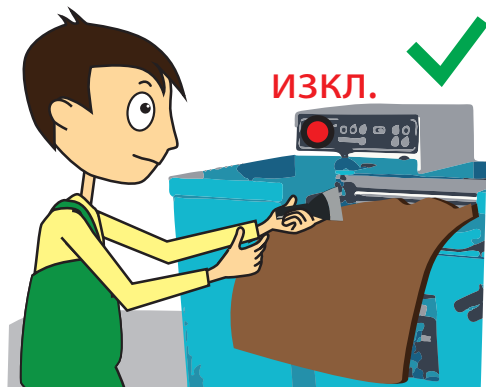
Фиг.3 Не поправяйте възникнали гънки по кожата при работеща машина. Спрете машината и оправете гънките със специалните дървени лопатки, а не с гола ръка.
