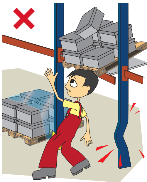
Фиг.4 Липсата на контрол върху състоянието на стелажите води до тежки наранявания.
