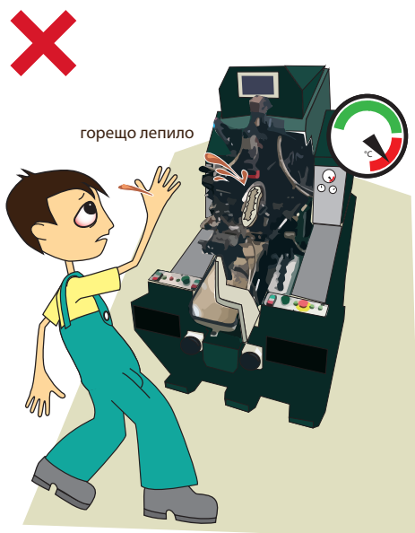
Фиг. 2 Неправилна работа. При липса на контрол на температурата и налягането се получават тежки изгаряния от лепилото и наранявания от налягането на флуида.
