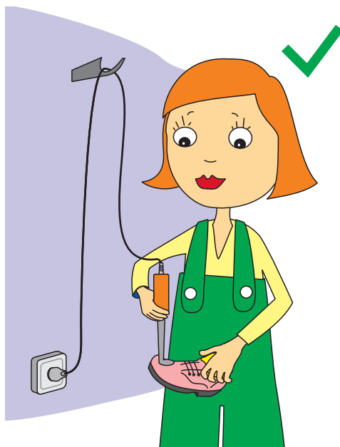
Фиг.1 Правилна работа. Пазете захранващия кабел далеч от горещи повърхности.
