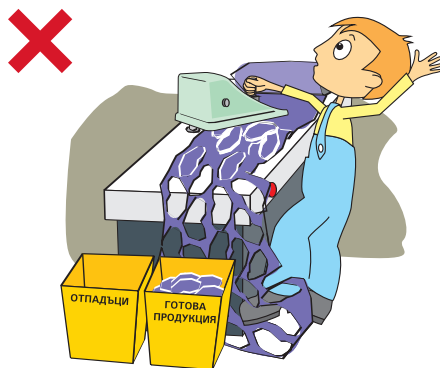
Фиг.2 Неправилна работа. Не работете така. Висящи части по разкроявания материал, могат да закачат командни и други устройства и да създадат причинят злополука.
