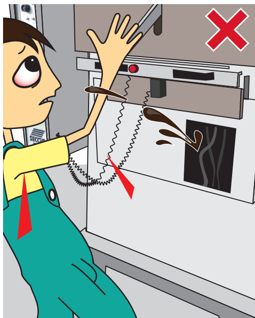
Фиг 4. Липсата на контрол на налягането и температурата води до пробиви в хидравличната система на машината и тежки наранявания от струята под налягане.
