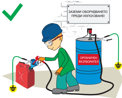
Фиг.3. При работа със запалими течности задължително заземявайте работното оборудване.
