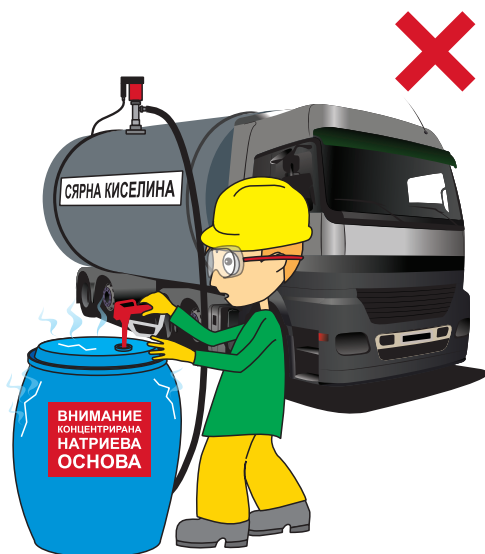
Фиг. 2. Не работете по този начин. Рискувате създаване на аварийна ситуация.
