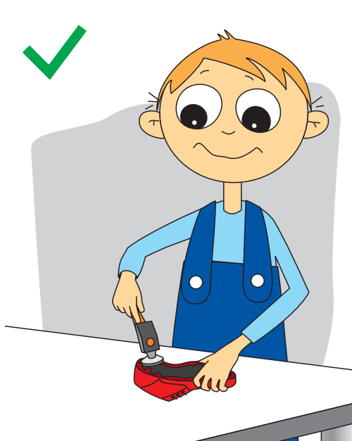
Фиг.3 Правилна работа с обуцарски чук. Без много усилия и замах.
