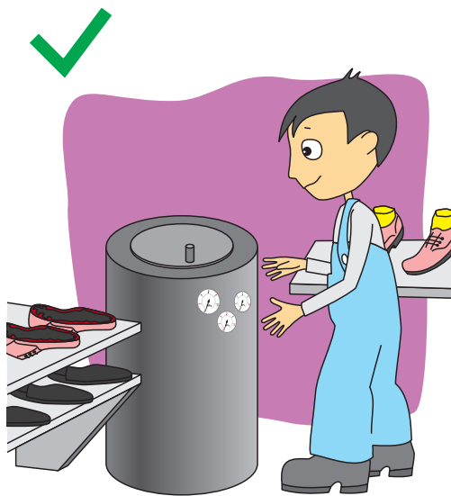
Фиг.1 Правилна работа. Следете капака на балонната преса да е плътно затворен, преди да се надует балоните.
