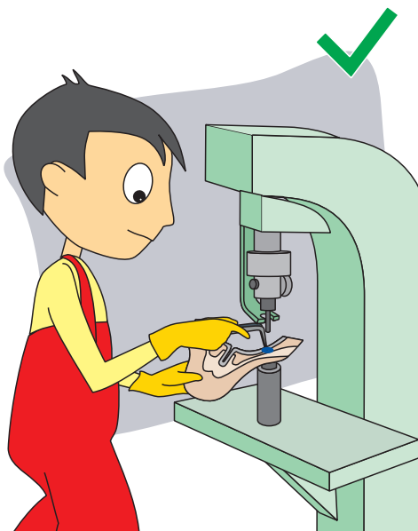
Фиг.3 Правилна работа. Настройката на машината за тик-так копчета се извършва само с подходящ инструмент. Това е правилния начин на работа.
