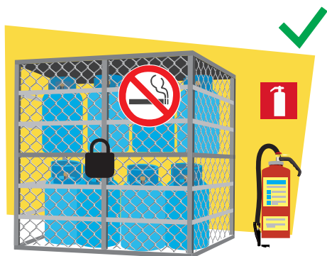
Фиг. 3 Това е правилния начин за съхраняване на газови бутилки.
