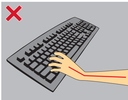
Фиг. 3 Недоброто разположение на клавиатурата предизвиква извиване на китките и работата не се извършва в неутрална позиция.
