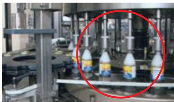
*Незащищен затварачен блок. Ръката на оператора може да влезе в опасната зона.*
