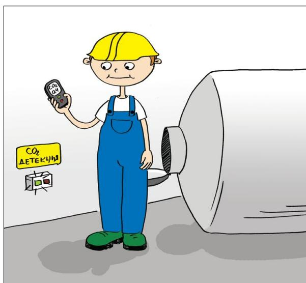
**Инсталирана фиксирана детекция и преносим газанализатор за CO<sub>2</sub>**
