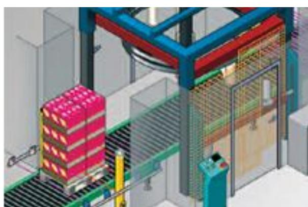
*Способност за различаване на човек от материал или готов продукт – различни комбинации от светлинни бариери (хоризонтални или вертикални), лазерни датчици, мътинг системи.*
