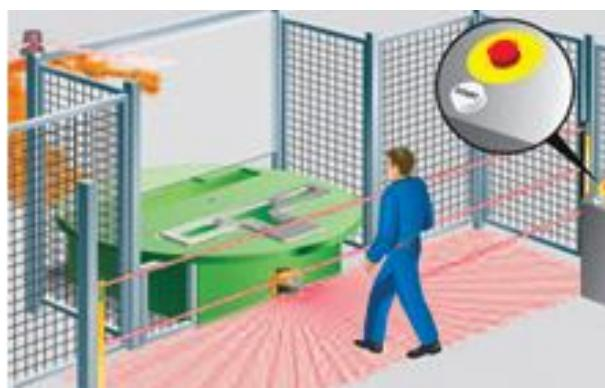
*Светлинна бариера, лазерна бариера и аварийен стол*
