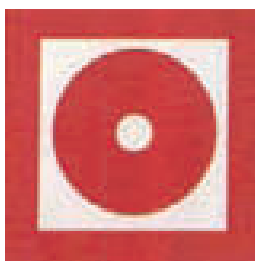
РЪЧНО ЗАДЕЙСТВАЩО СЕ ПОЖАРОГАСИТЕЛНО ИЛИ ИЗВЕСТИТЕЛНО УСТРОЙСТВО
